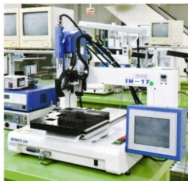
画像認識付注型機 一液または混合・攪拌された二液の樹脂をポッティングする装置
