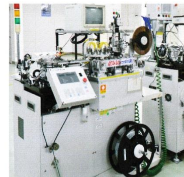
テーピングマシン キャリアテープに製品を挿入し熱シールしリールへ巻き取る装置
