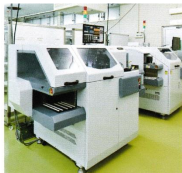
ダイボンダー ウエハーから切り離されたチップをリードフレーム・基板に接着固定する装置
