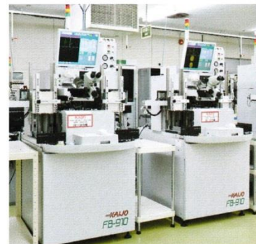
ワイヤーボンダー Au線などでチップなどと電極間を配線する装置
