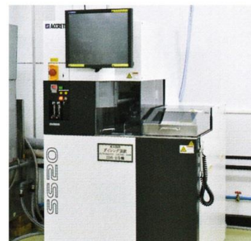
ダイシングソー 高速回転するスピンドルの先端に取り付けられた極薄外周刃により被加工物を切断又は切溝を加工する装置
