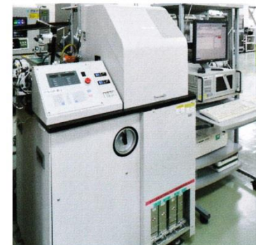
LEDテスター 電気的特性および光学的特性を測定し、分類する装置
